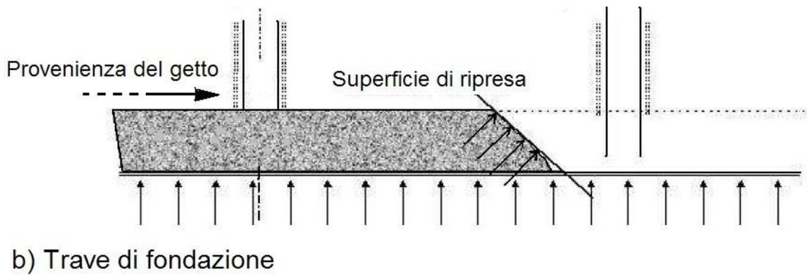
Figura 3 - Modalità di ripresa del getto in travi di piano e di fondazione
