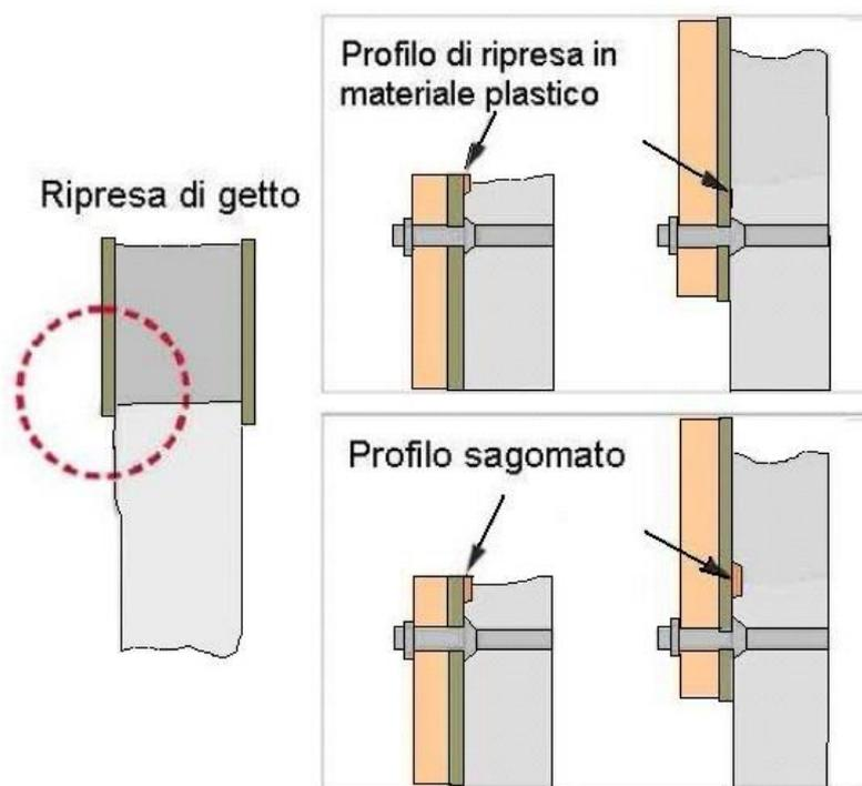
**Figura 8 - Giunti delle casseforme in evidenza**
